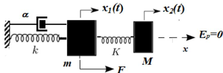
**Figure 3 : Modèle physique d'un éteuffeur dynamique des vibrations**
