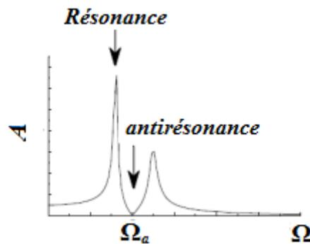
**Figure 42.5 : Phénomène de résonance et antirésonance**
