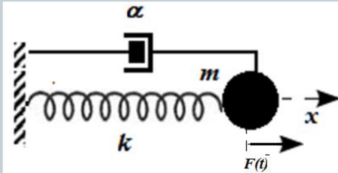
Figure 1 .4 : Schéma d'un mouvement forcé
