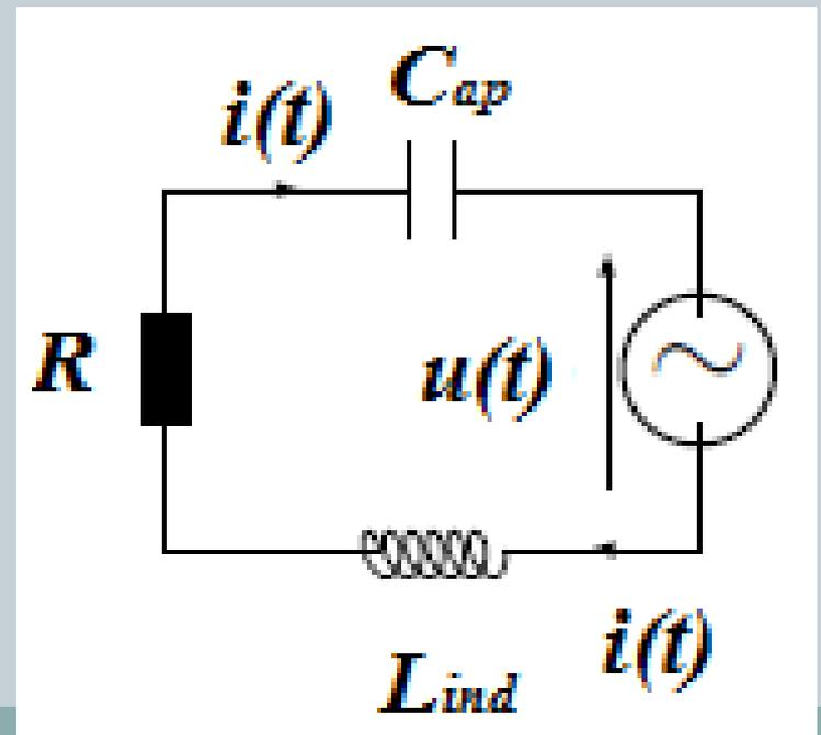
**Figure 5.4 : Circuit oscillant R.L.C alimenté par Une source de tension extérieure**
