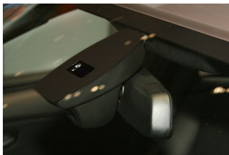
FIGURE : Détecteur de pluie dans une voiture
