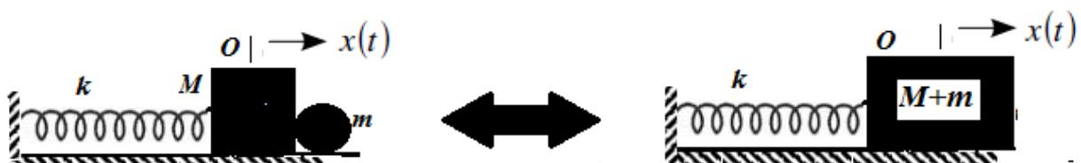
**Figure 5 : Système est équivalent à un oscillateur simple**
